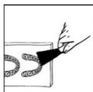
Fertig gedruckte Arbeiten sowie jegliche polymerisierte Reste mit einem Spachtel von der Bauplattform entfernen.
