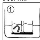
Druckobjekte in einem separaten Gefäß mit SHERAultra-p für maximal drei Minuten im Ultraschallbad reinigen. Öffnungen, Bohrungen und Spaltbereiche mit einer weichen Zahnbürste vorsichtig abbürsten.
